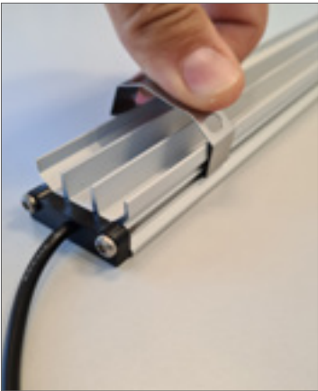
Bild 3: Spreizen Sie den Aufhängebügel leicht auseinander damit dieser über die Kühlrippen der gegenüberliegenden Seite der FLEX II ragt.
