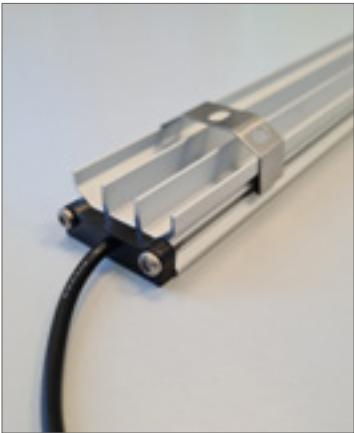
Bild 4: Mit leichtem Druck auf den Aufhängebügel rastet dieser auf der gegenüberliegenden Längsrille ein.
